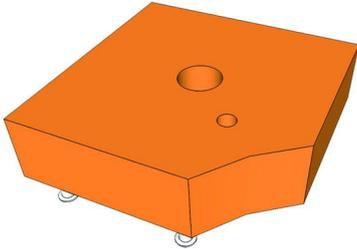
Modulo angolare da utilizzare come base per il tubo a bolle e le fibre ottiche
