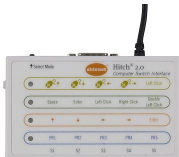
**Hitch 2.0 Interfaccia USB per 5 sensori per computer, molto compatta e semplice, anche programmabile.**
