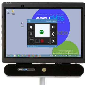
Sistema per il controllo del computer e per la comunicazione a puntamento oculare basato su telecamera IntelliGaze.
